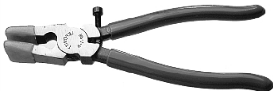
32 115 00 PROVETRO - rozlamovací kleštky PRP-1, kovové, délka 205 mm, šířka čelistí 24 mm, stavací šroub pro sílu lámání skla, rukojeti i čelisti potažené umělou hmotou. Jsou velice výhodné při lámání pruhů a pro svoji životnost a cenu patří tyto kleštky mezi nejoblíbenější a neschází ve vybavení každého, kdo zpracovává ploché sklo. Určeno pro sílu skla 2 - 6 mm
