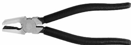
32 133 00 PROVETRO - lámací klešty PCJ-4, šířka lámacích čelistí 22 mm, použití pro lámání dlouhých tenkých proužků skla, odlamování ze strany, určeno pro sílu skla 2 - 12 mm
