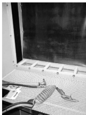
pohled do vnitřního prostoru pískovací kabiny
