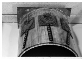
Příklad použití ohýbací formy - sklo na formě před a po ohnutí
