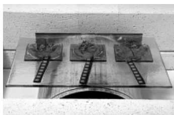
Příklad použití ohýbací formy - sklo na formě před a po ohnutí
